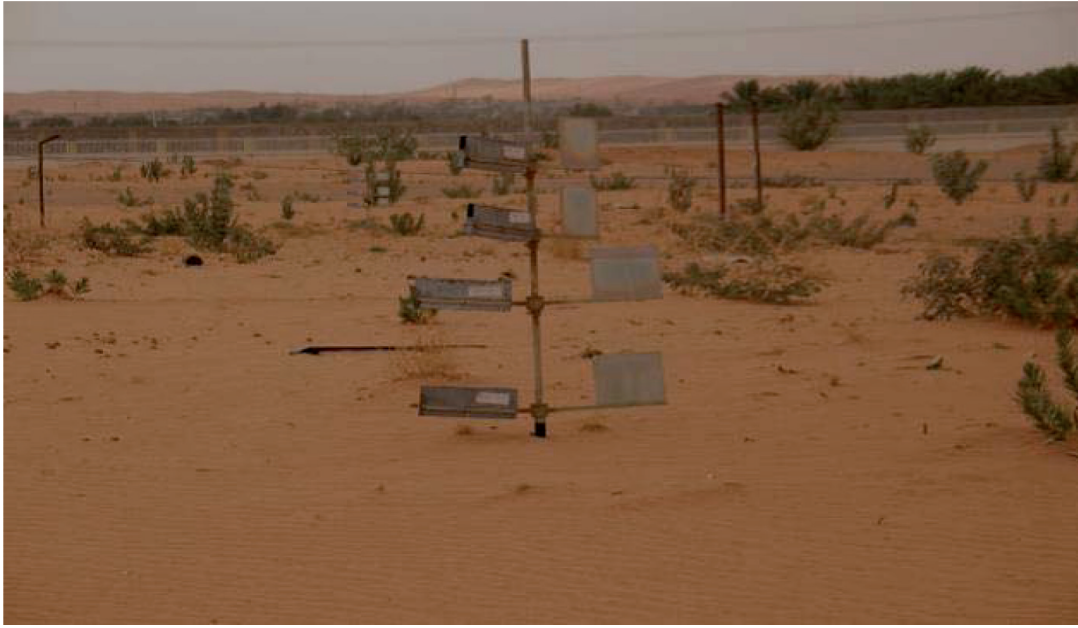
الشكل رقم (١). مصائد الغبار التي استخدمت لتجميع المادة المنجرفة من محطة تربية الإبل (الموقع المكشوف) بالمزاحمية.
