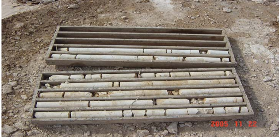
الشكل الرقم (١٠). نتيجة الحفر الاختباري عند المسافة ٤٧,٧٥ م من المقطع الكهربي الرابع وبع عمق ٧ م، حيث أن البداية من أسفل اليمين.
