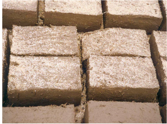
صورة رقم ٧: التبن على سطح الطوب لحماية الطوب من التشققات
