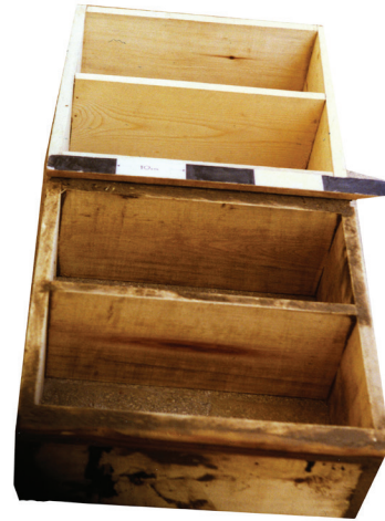
صورة رقم ٤: القالب الخشبي المستخدم في عملية الصناعة
