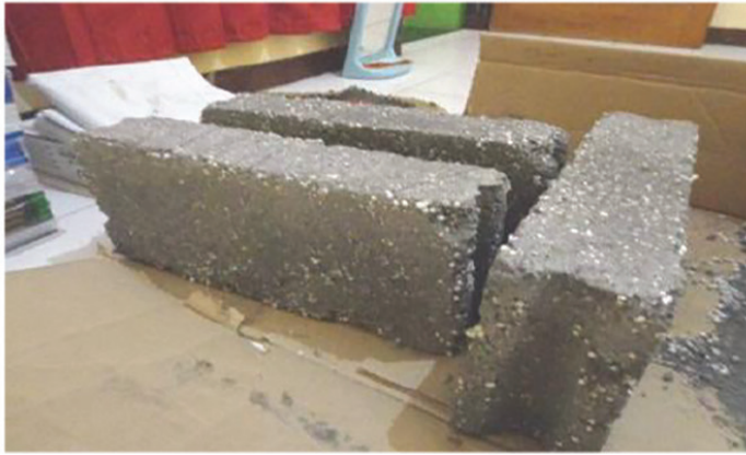
الشكل رقم (٨). صورة المنتج النهائي لاستخدام الستاير وفوم وقصب السكر بالخرسانة - المرجع (Setyowati,2014).
