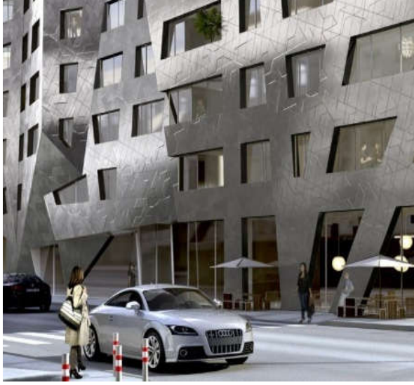
الشكل رقم (٣). واجهات مبنى Sapphire التي تتمتع بخاصية تنقية الهواء والتنظيف الذاتي - المرجع: (J. Wiegmann, 2014)
