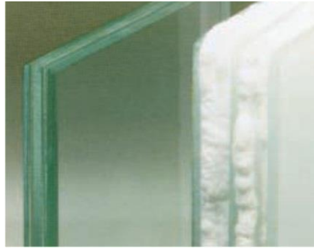
الشكل رقم (٢٥): الزجاج المقاوم للحريق قبل تعرضه للحرارة وبعده (G.James,2012)
