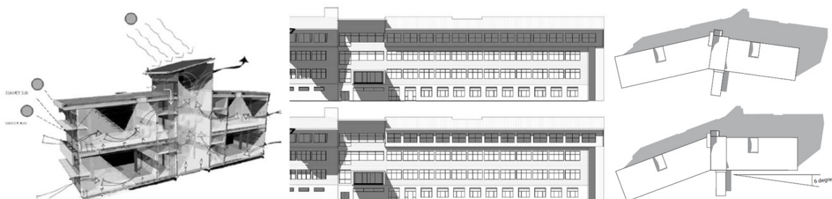
الشكل رقم (٩). تأثير اختيار التوجيه الصحيح على تقليل الطاقة المكتسبة على واجهة المبنى والاستفادة من التهوية الطبيعية (Krygiel and Nies, 2008: pp. 133-138).
