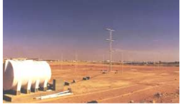
(أ) منظر لموقع الحالة الاختبارية حيث عمود نفث رذاذ الماء على أربعة مستويات بجانب خزان المياه.
