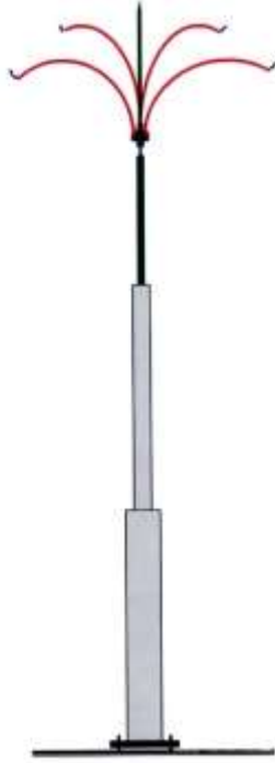
الشكل رقم (١). رسم توضيحي لعمود نفث رذاذ الماء. المصدر: (السليمانى وبار، ١٤١٨هـ).
