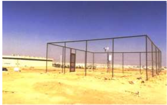
(ب) منظر لموقع الحالة الأساسية بدون نفث رذاذ الماء. الشكل رقم (٣). منظر لموقع الحالة الأساسية والحالة الاختبارية لتجربة قياس فعالية أداء عمود نفث رذاذ الماء على أرض جامعة الملك سعود، الرياض.
