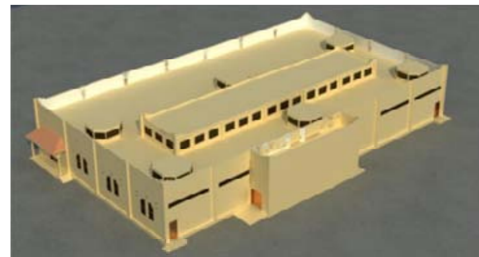
الشكل رقم (٦). منظور ثلاثي الأبعاد للتجربة الأولى البديل التصميمي إضافة ستة مناوور علوية بالسقف الواجهة الشمالية الغربية.
